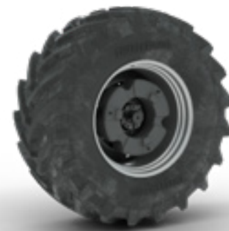
A hátsó kerekre akár összesen 2 500 kg pótsúly szerelhető.
