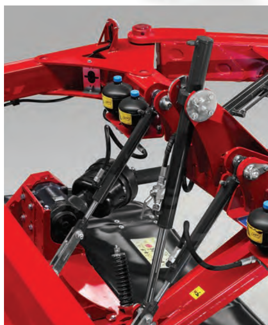
Systém hydraulického odlehčení žací lišty zajišťuje čistý řez a delší životnost stroje.
