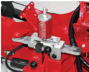
Přímý pohon na první žací disk přes kloubový hřídel, úhlovou převodovku a dvojitý křížový kloub.
