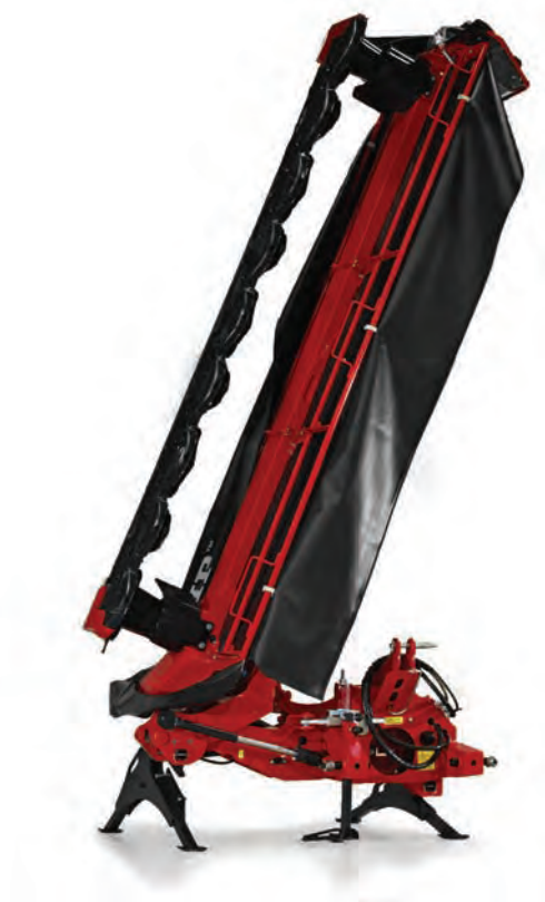
Před přepravou lze stroj otočit za traktorem o 120° a odstavit jej na ploše pouhých 3,2 m 2 .
