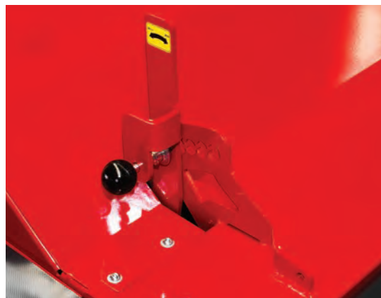
Intenzitu kondicionéru lze nastavit.
