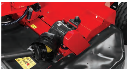
Speciální převodovka na žací liště garantuje snížení zatížení kloubového hřídele.
