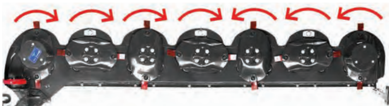
Do středu Lze vytvářet užší řádky a dosahovat efektivnějšího sečení v extrémně svažitém terénu.
