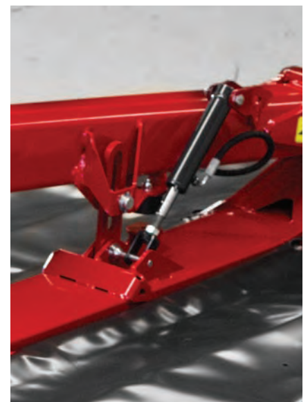
Stabilizace žací lišty pomocí hydrauliky umožňuje sekvenční zvedání žací lišty. Nejprve se zvedne vnitřní strana žací lišty a poté vnější strana.
