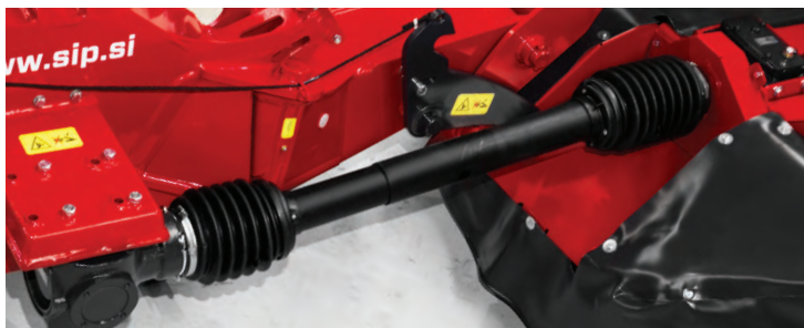
Přímý pohon na prvním žacím disku přes kloubový hřídel, úhlovou převodovku a dvojitý křížový kloub
