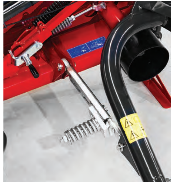
CSS (mechanická pojistka proti přetížení)
