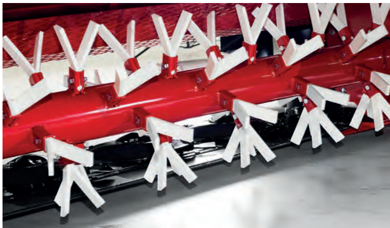
Intenzitu kondicionéru lze nastavit.
