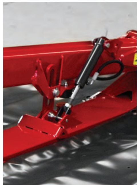
Stabilizace žací lišty pomocí hydrauliky umožňuje sekvenční zvedání žací lišty. Nejprve se zvedne vnitřní strana žací lišty a poté vnější strana.
