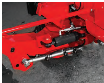
Přímý pohon na první žací disk kloubovou hřídelí a úhlovou převodovkou.
