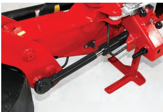
Hydropneumatické odlehčení žací lišty.
