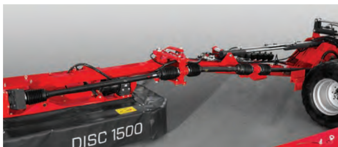
Přímý pohon na první žací disk kloubovou hřídelí a úhlovou převodovkou.
