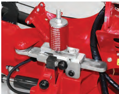
Přímý pohon na prvním žacím disku přes kloubový hřídel, úhlovou převodovku a dvojitý křížový kloub
