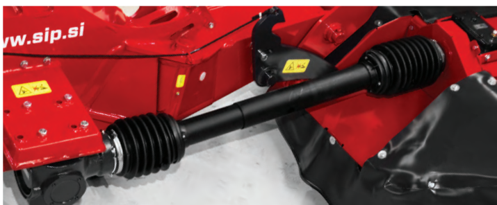
Přímý pohon na první žací disk přes kloubový hřídel, úhlovou převodovku a dvojitý křížový kloub.
