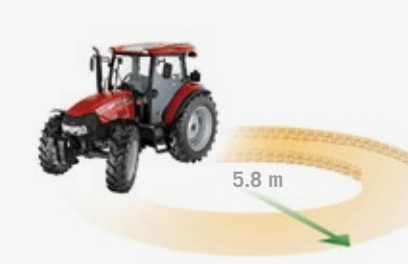
Minimální poloměr otáčení 5,8 m
