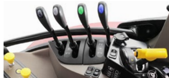
Modely s čistě mechanickými zadními okruhy umožňují také snadné ovládání ergonomickými pákami.
