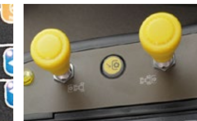
Elektrohydraulická aktivace zadního i předního vývodového hřídele.
