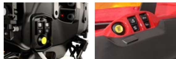
Na přední i na zádi traktoru jsou externí ovladače pro hydraulické ovladače, vývodový hřídel a přídatnou řídicí jednotku.
