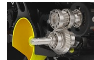
Přímý přenos výkonu z motoru na přední vývodový hřídel.
