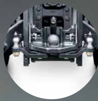
Připojení K80 Ideální pro náročný provoz s přívěsem je kulové připojení K80. Lze ho zasunout, výškově nastavit a demontovat pro lepší přístup k vývodovému hřídeli. K80 můžete svísele zatížit až 4 000 kg a lze využít tak maximálně nosnost traktoru a zadní nápravy.
