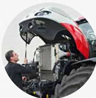
Jednoduchou kapotu motoru lze zvednout do dvou poloh (45°/90°), dokonce i s připojeným nářadím.
