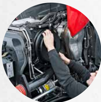
Nepřetržitě čištění přes cyklonový filtr zajišťuje, že se musí provádět údržba filtru jen při rozsvícení příslušné kontrolky.
