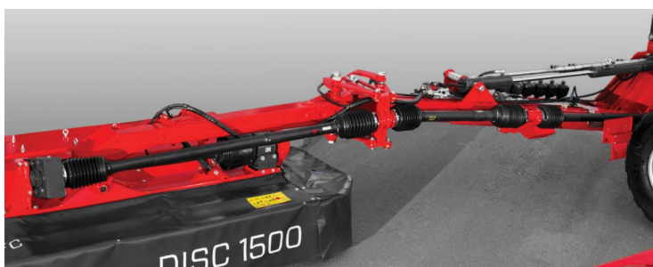
Přímý pohon na první žací disk kloubovou hřídelí a úhlovou převodovkou.
