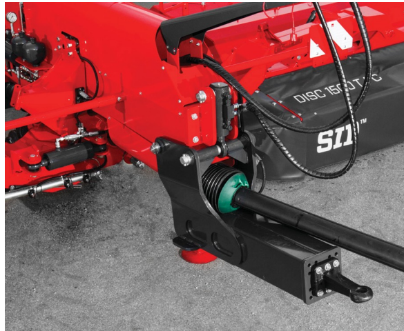
Hydraulicky nastavitelný závěs podvozku umožňuje optimální polohu bez ohledu na výšku závěsu.
