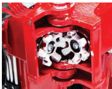
Zubová spojka zajišťuje tichý chod a vyšší únosnost stroje.
