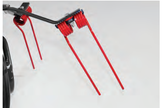
Držáky prstů s pojistkou proti ztrátě prstů
