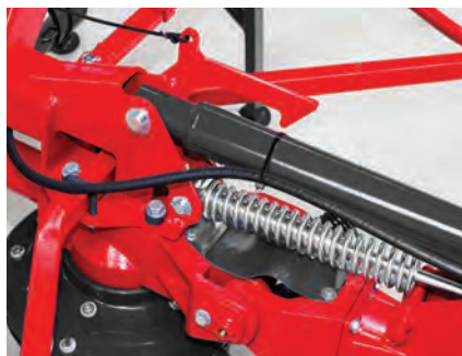
Robustní uzavřené pohony s ozubenými koly mazanými tukem pro klidný chod rotoru.
