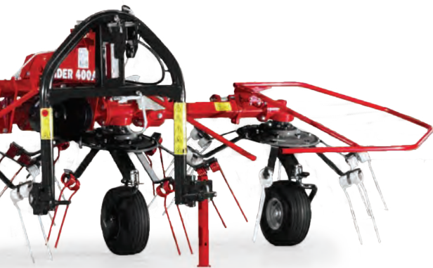
Hydraulické zvedání vnějších rotorů umožňuje snadnou manipulaci se strojem přímo ze sedadla pro řidiče (SPIDER 600|6 ALP a SPIDER 400|4 ALP standardně, SPIDER 350|4 ALP a 400|4 ALP* DODATEČNÉ VYBAVENÍ).
