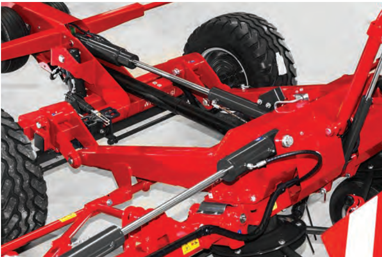
Nastavení sklonu rotorů (patent SIP) od 15° do 21° (na přání hydraulicky) pro dosažení rovnoměrného rozhozu.
