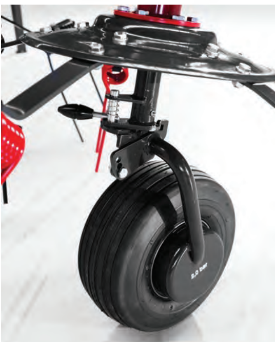
Kola s rozhozem na hranici pole a s výškovým nastavením rotoru (SPIDER 400|4 ALP, 600|6 ALP)
