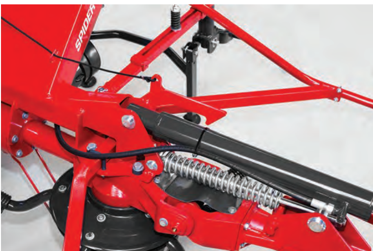
Hydraulické skládání rotorů lze ovládat přímo z kabiny traktoru.
