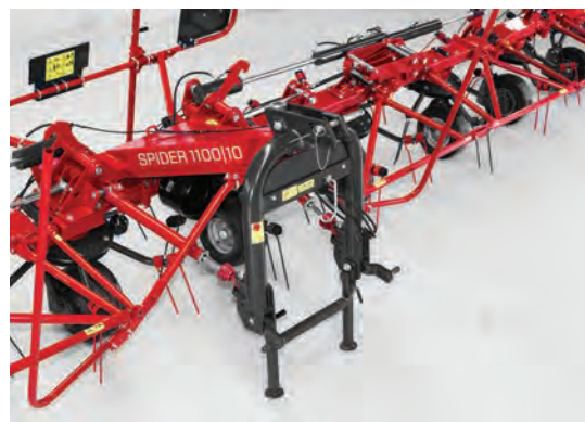
Kyvňý čep umožňuje díky stabilizátorům snadné kopírování stopy traktoru.
