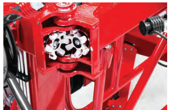
Zubová spojka je bezúdržbová a garantuje spolehlivý přenos síly za veškerých pracovních podmínek.
