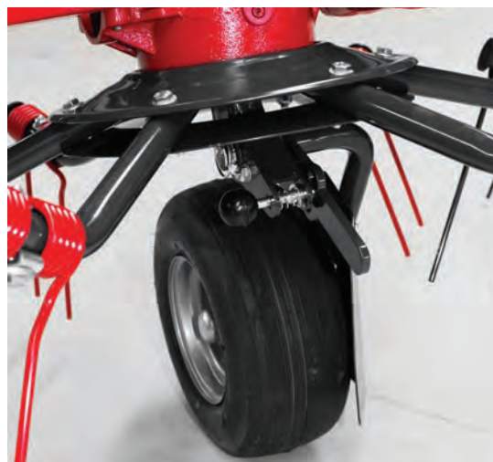
Kola s víceúhňovým nastavením výšky a rychlé nastavení úhlu rozhozu s koly, která lze posunovat.
