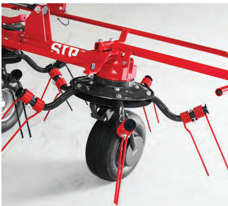
Rotor a ramena pružinových prstů jsou při otáčení vystaveny působení vysoké síly, a proto se vyrábějí z robustních trubek kruhového průřezu. Pro další vyztužení ramen pružinových prstů se používá spodní kroužek na rotoru.
