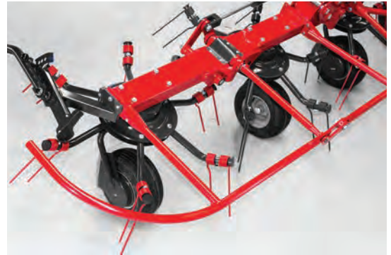
Propojené kryty pro zajištění dodatečné stability a tuhosti.
