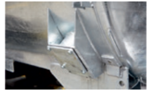
Alapfelszereltségben csatlakozó karimák elől, jobb és bal oldalon, valamint hátul
